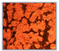
Plate (d) Micrograph of as-cast sand casting for AA6063/SiC (X200)
