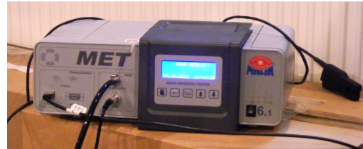
Figure 3. MAHA MET 6.1 exhausts analyser
